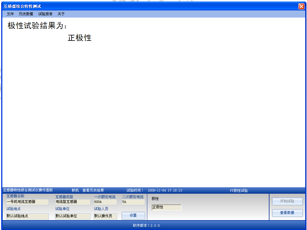
图 5.15 极性试验结果显示
